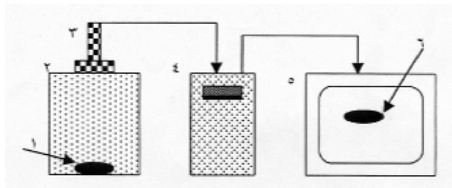
شکل ۱. طرح‌واره سیستم بینایی ماشین شامل دانه (۱)، دوربین (۲)، جعبه نور (۳)، رایانه (۴)، صفحه نمایش (۵)، و تصویر دانه (۶)
