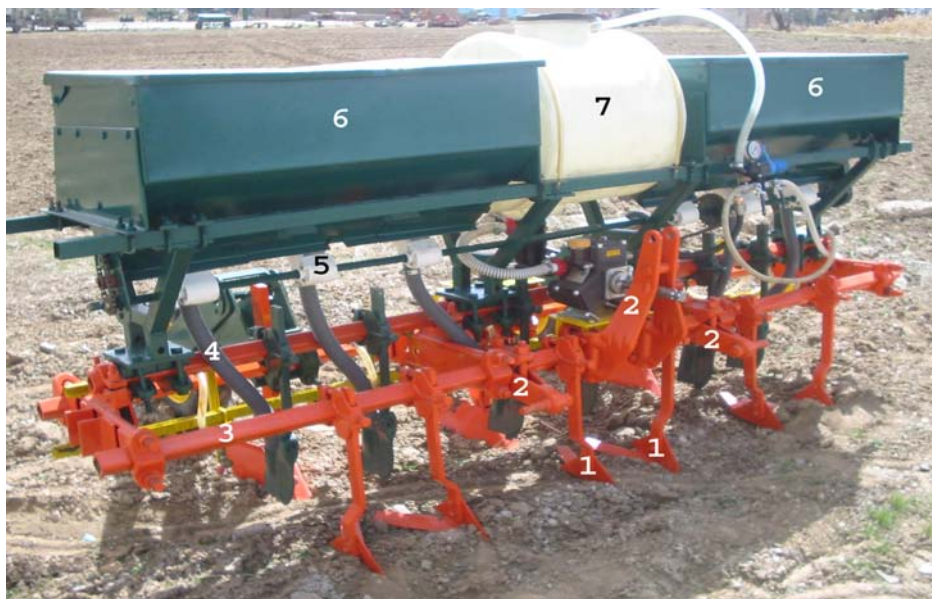
شکل ۱. ماشین کمبینات (دید از جلو) ۱- تیغه سرنیزه‌ای ۲- سه نقطه اتصال به تراکتور ۳- تیرک افزار ۴- لوله سقوط ۵- مقسم کود ۶- مخزن کود ۷- مخزن سم
