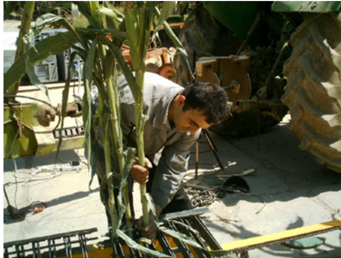
شکل ۷. قرارگیری ذرت‌ها روی ریل کالیبراسیون
