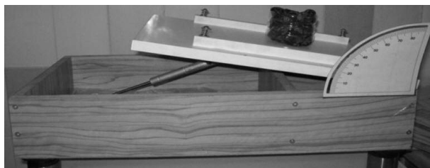
شکل ۱. دستگاه تعیین ضریب اصطکاک ایستایی
