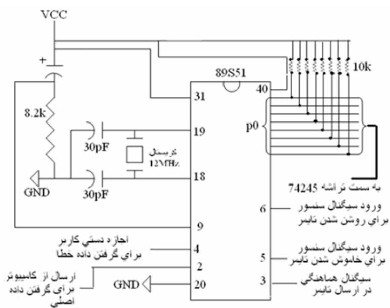
شکل ۴. مدار واسط دیجیتالی، در این مدار سیگنال‌های ارسالی از سنسورها به پایه‌های شماره ۵ و ۶ وارد شده و تایmer را روشن و خاموش می‌کند. داده‌ها به صورت ۸ بیتی از پورت صفر ارسال می‌شود.
