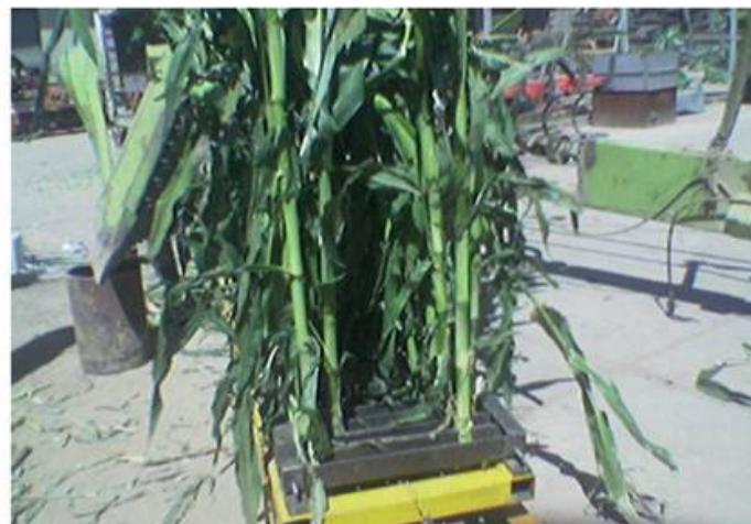
شکل ۶. ریل کالیبراسیون، همان‌طور که در شکل نشان داده است دو ردیف ذرت به صورت ایستاده و در شرایطی کاملاً شبیه مزرعه روی ریل قرار گرفته و با سرعتی ثابت وارد دهانه چاپ می‌شود.
