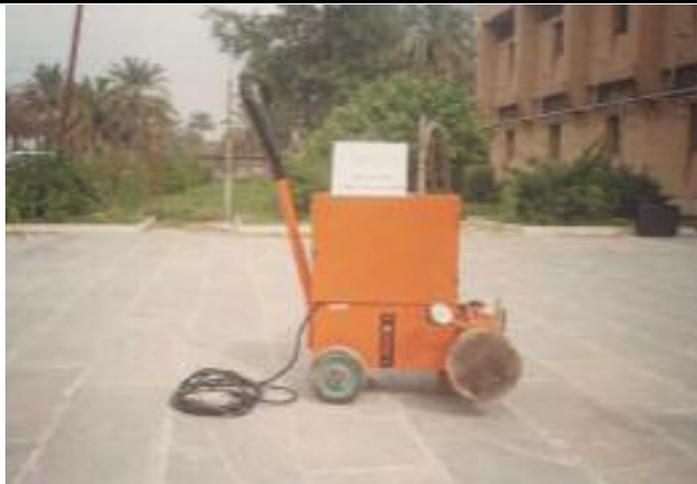
شکل ۴. نمایی از دستگاه مقاومت برشی در محل
