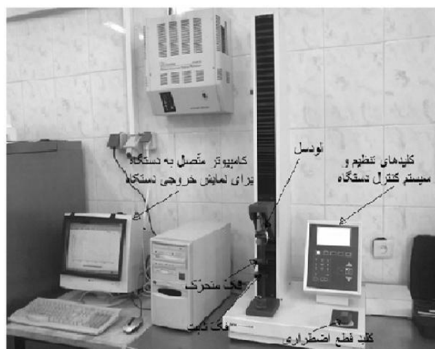
شکل ۲. نمونه میوه خرما تحت بارگذاری فشاری (سمت راست)، دستگاه آزمون مواد Hounsfield H5k-s (سمت چپ)
