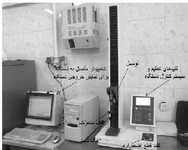
شکل ۲. نمونه میوه خرما تحت بارگذاری فشاری (سمت راست)، دستگاه آزمون مواد Hounsfield H5k-s (سمت چپ)
