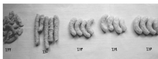
شکل ۲. تأثیر مقادیر مختلف رطوبت بلغور ذرت بر حجم اسنک‌های تولیدی پس از خروج از اکسترودر
