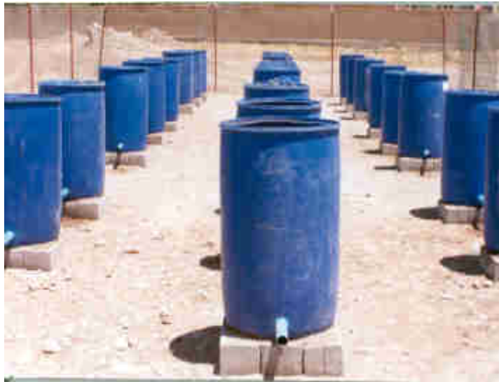
شکل ۱. مجموعه لایسیمترهای کارگذاری شده در مزرعه
