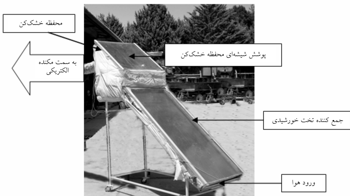
شکل ۱. خشک کن خورشیدی مورد استفاده در طرح
