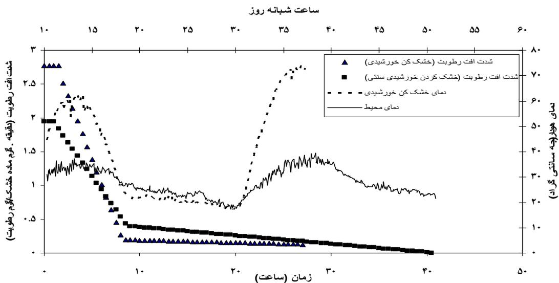
شکل ۶. شدت افت رطوبت ورقه‌های گوجه‌فرنگی با ضخامت ۱ سانتی‌متر و تغییرات دمای هوا در دو روش خشک‌کردن خورشیدی
