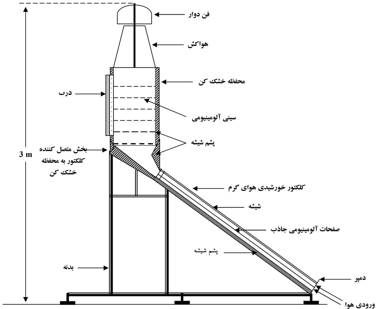
شکل ۱. شماتیک مقطع عرضی خشک کن خورشیدی
