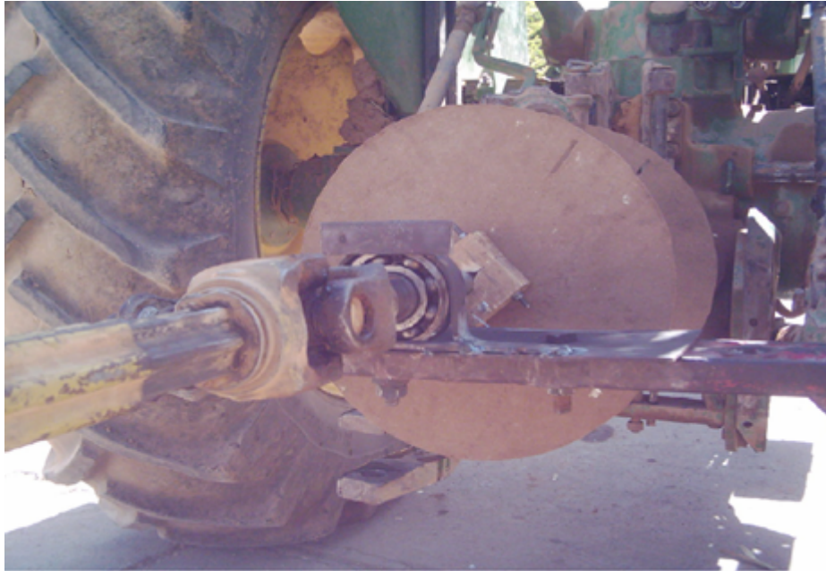
شکل ۳. اتصال محور پیچشی از یک طرف به ترکتور و از طرف دیگر به چاپر
