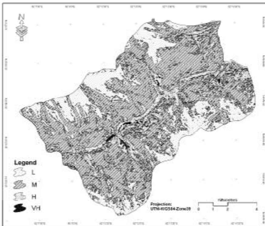
شکل ۹. نقشه خطر لغزش با اپراتور گامای ۰/۹۷۵
