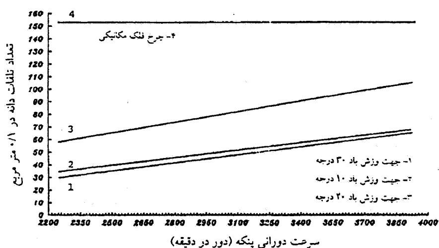
شکل ۱۳. تلفات دانه توسط چرخ فلک مکانیکی و بادی در ۱/۰ مترمربع، بر حسب دور پنکه
