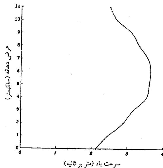
شکل ۱۰. پروفیل سرعت باد خروجی در پهناهی دهانه پنکه (در فاصله ۴۰ سانتی‌متری از دهانه، سرعت دورانی پنکه ۲۲۴۷ دور در دقیقه)
