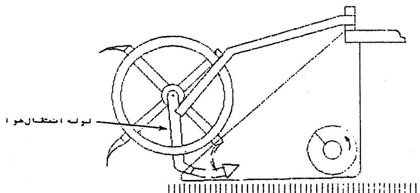
شکل ۳. تصویر شماتیک چرخ فلک انگشتی - بادی
