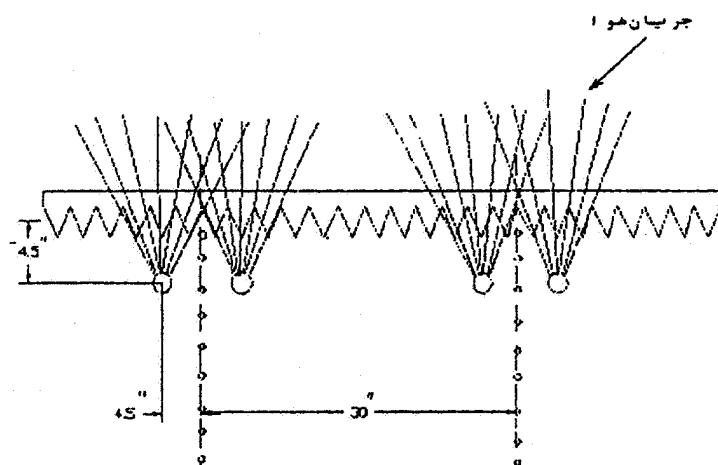
شکل ۲. تصویر شماتیک از آزمون آزمایشگاهی برداشت سویا (۷)
