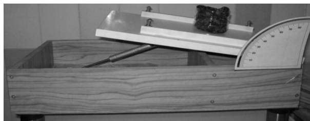
شکل ۱. دستگاه تعیین ضریب اصطکاک ایستایی
