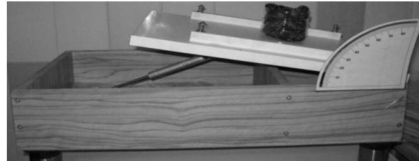
شکل ۱. دستگاه تعیین ضرب اصطکاک ایستایی
