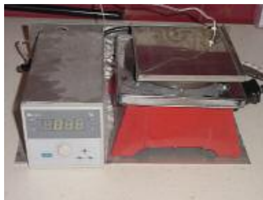
شکل ۱. دستگاه اندازه‌گیری دمای نقطه چسبندگی
