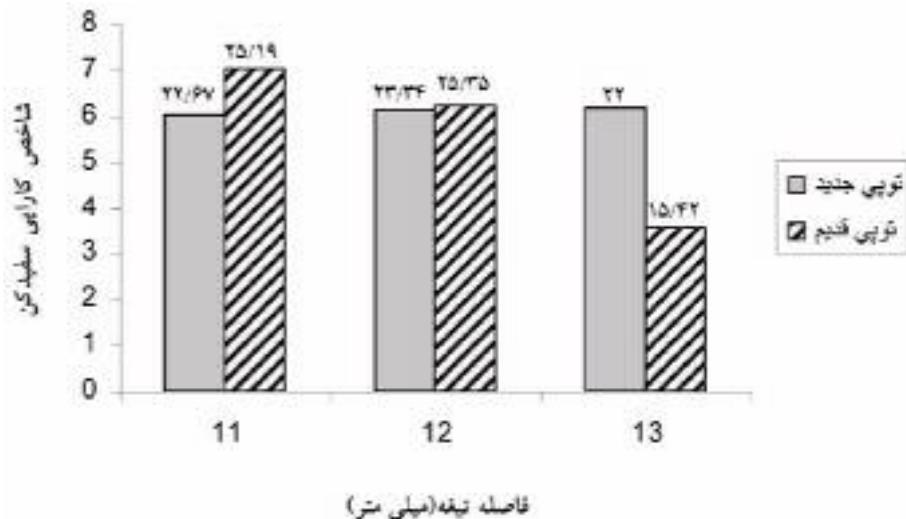
شکل ۶. مقادیر شاخص کارایی سفیدکن و میزان شکستگی برنج در فواصل مختلف نیفه از همزن
