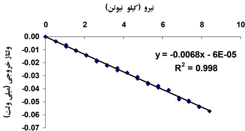
شکل ۱۵. تغییرات ولتاژ خروجی پل و تستون مربوط به راستای X با مؤلفه افقی ( $F_x$ ) بار اعمال شده تحت زاویه ۴۵ درجه به مبدل نیروی بالایی.
