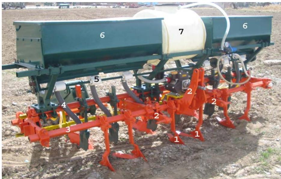
شکل ۱. ماشین کمبینات (دید از جلو) ۱- تیغه سرنیزهای ۲- سه نقطه اتصال به تراکتور
