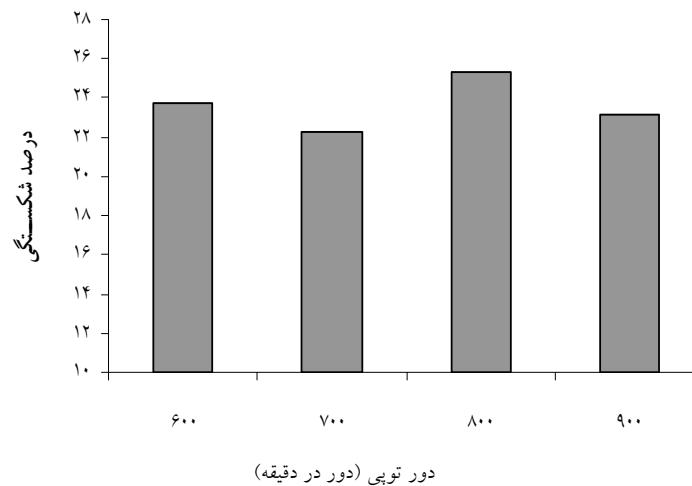
شکل ۴. اثر دور توپی بر درصد شکستگی
