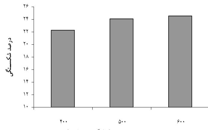
شکل ۵. اثر دبی خروجی بر درصد شکستگی
